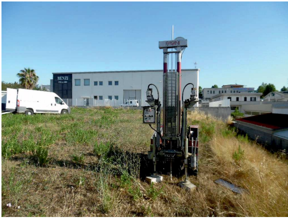
foto 1-2: esecuzione prove penetrometriche dinamiche super pesanti Dpsh1 e Dpsh2
