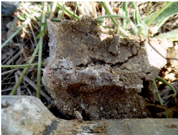
foto 3-4: litotipo "a" Limo argilloso sabbioso concrezionato riscontrato sulle aste penetrometriche dopo l'esecuzione delle prove in situ.
