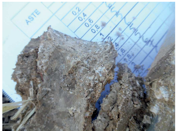
foto 3-4: litotipo "a" Limo argilloso sabbioso concrezionato riscontrato sulle aste penetrometriche dopo l'esecuzione delle prove in situ.
