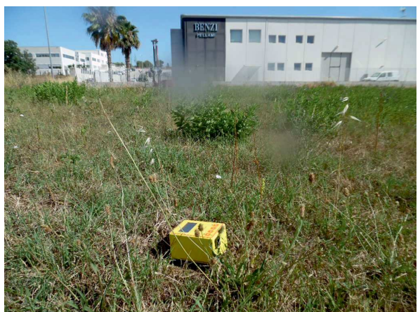
foto 5-6: esecuzione rilievo sismico passivo con tecnica HVSR e registrazione mediante tromografo digitale
