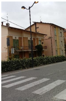
Palo dritto con braccio con doppio apparecchio di arredo urbano con funzioni di illuminazione stradale
