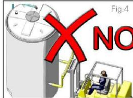
Come già detto, il sollevamento o la movimentazione deve avvenire inserendo nei golfari funi di sollevamento provviste di ganci e di bilancino (vedi fig. 5) e quindi impiegare una gru o un carro ponte per la movimentazione (vedi fig. 6). Se il serbatoio è dotato di vasca (VCA e VCC) usare i golfari della vasca e non del serbatoio (vedi fig. 5).
