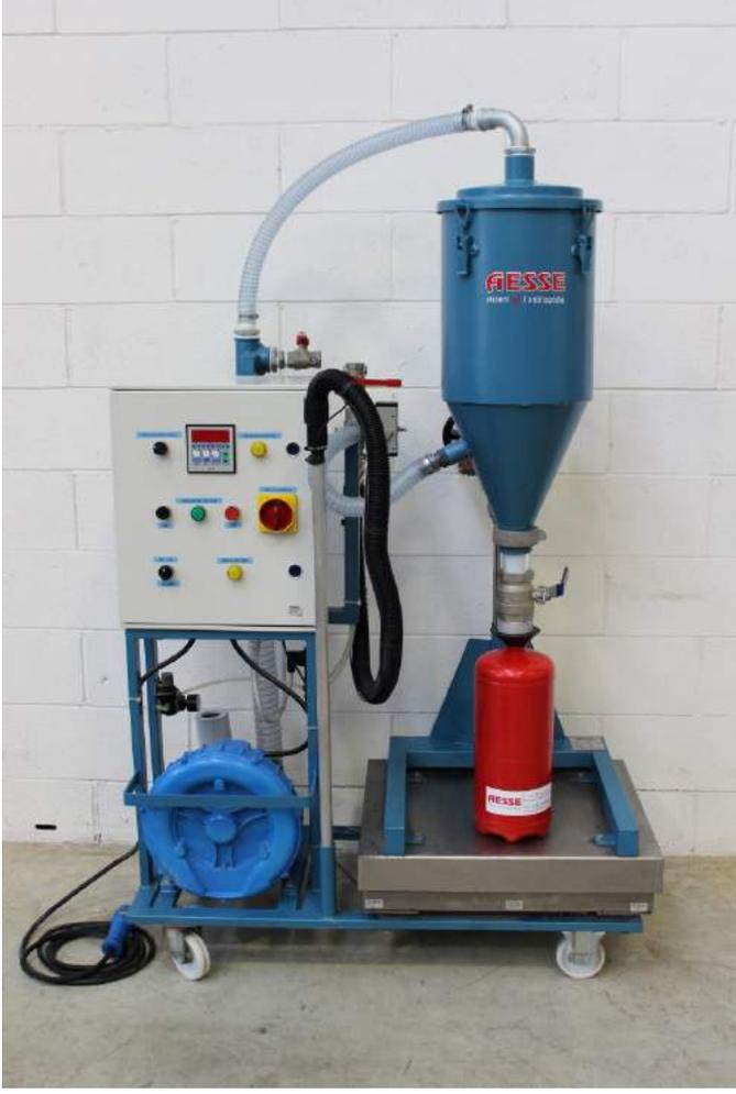
Apparecchiatura per il caricamento e lo svuotamento di serbatoi per estintori a polvere con controllo automatico del peso per i portatili.
