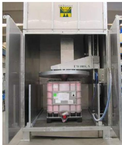
E' possibile completare l'impianto con la fornitura di una cabina di contenimento che sarà realizzata in tubolare Fe verniciato epossidicamente (oppure zincato su richiesta) e rivestita con pannelli di lamiera in acciaio inox AISI 304.
