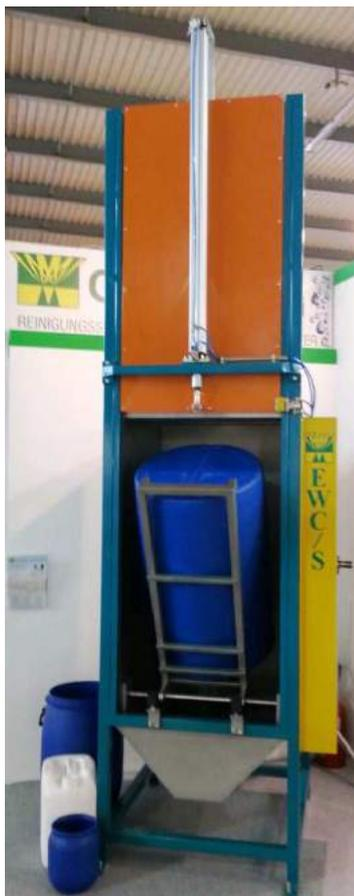
L'impianto di lavaggio modello EW100/S verrà collegato ad una postazione per il lavaggio dei fusti a singola postazione realizzata in Fe verniciato epossidicamente e tamponata con pannelli in acciaio inox.
