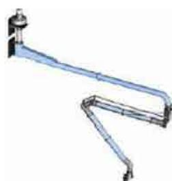
SERIE ELB: prolunga a bandiera ELB, completa di aspiratore, con braccio con tubi in alluminio, rotazione 180° + 360°, corredato di serranda di esclusione e di mensola di sostegno a parete.
