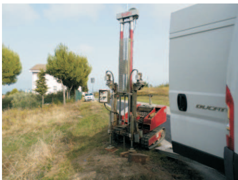
foto 1: esecuzione prova penetrometrica dinamica super-pesante Dpsh1
