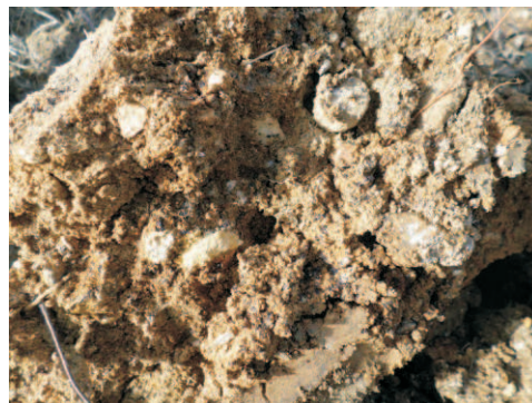
foto 3-4: litotipo "a" Limo argilloso sabbioso concrezionato con ciottoli riscontrato in affioramento a valle delle prove in situ eseguite.
