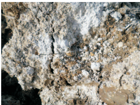
foto 3-4: litotipo "a" Limo argilloso sabbioso concrezionato con ciottoli riscontrato in affioramento a valle delle prove in situ eseguite.
