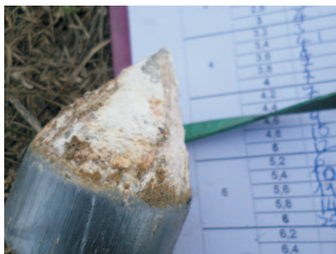
foto 5: sedimenti sabbiosi appartenenti alla formazione marina arenacea (litotipo "b") riscontrati sulla punta penetrometrica dopo l'esecuzione delle prove in situ.
