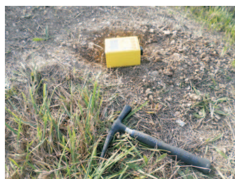
foto 6, 8: esecuzione rilievo sismico passivo con tecnica HSRV e registrazione mediante tromografo digitale. Trace Tr1 e Tr2.
