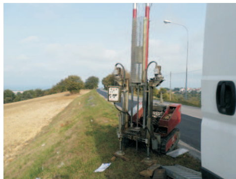
foto 2: esecuzione prova penetrometrica dinamica super-pesante Dpsh2
