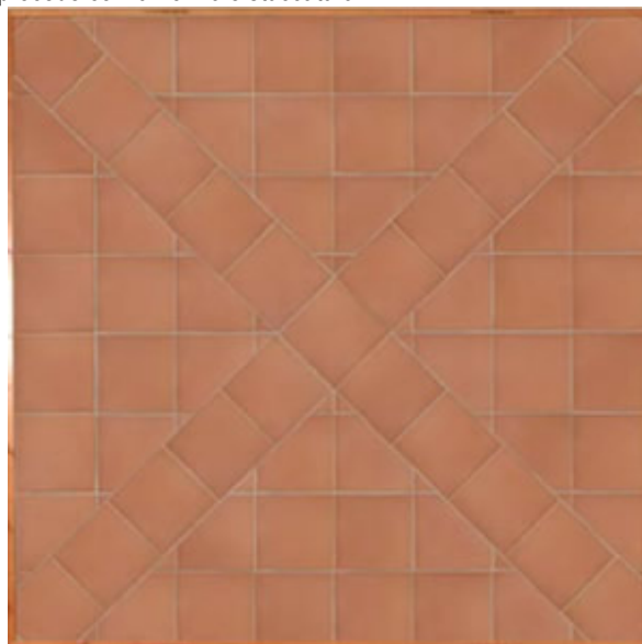
Schema per la posa in opera del cotto quadro di formato cm 30x30 per ambienti di grandi dimensioni.
