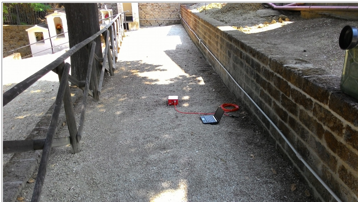
Fig. 2 – SARA Geobox in posto per la registrazione.
