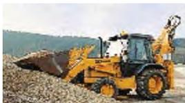
Trattasi della movimentazione del terreno mediante l'ausilio di specifiche macchine per effettuare riempimenti, spostamenti e rilevati
