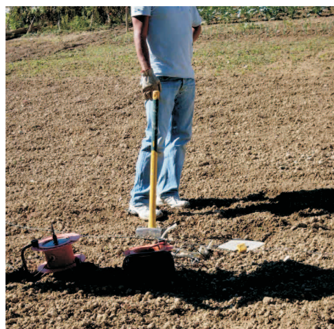
STENDIMENTO/STESA SISMICA A RIFRAZIONE PROFILO A-A particolare impulso onde nel sottosuolo mediante battitura con mazza
