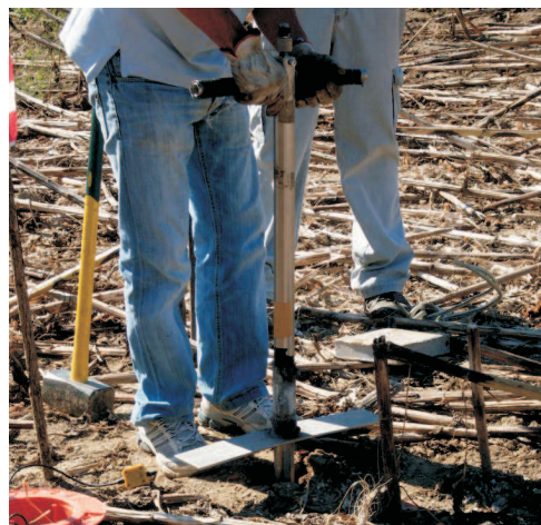
STENDIMENTO/STESA SISMICA A RIFRAZIONE PROFILO A-A particolare impulso onde nel sottosuolo mediante fucile sismico
